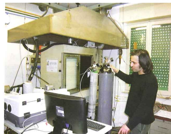
Apparecchiatura camera ISO 5659.2 versione TRANSFEU durante la calibrazione con bombola certificata di HCl in azoto
